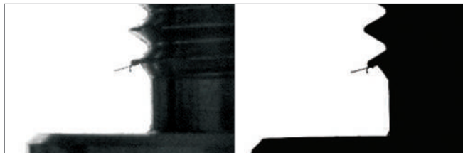
Image de gauche : bords flous avec système de rétroéclairage standard. Sur l'image de droite, contours nets à l'aide d'un système d'illumination télécentrique
